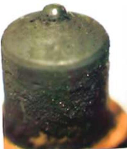
Az injektor állapota 911 üzemóra után normál gázolaj használata esetén!
