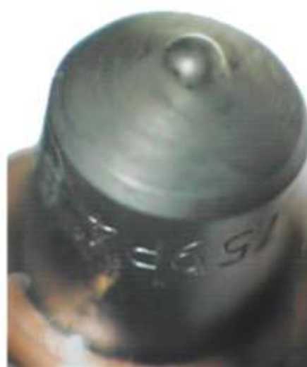
Ugyanaz az injektor tisztítás nélkül 176 üzemóra után kondicionált gázolajat használva!
